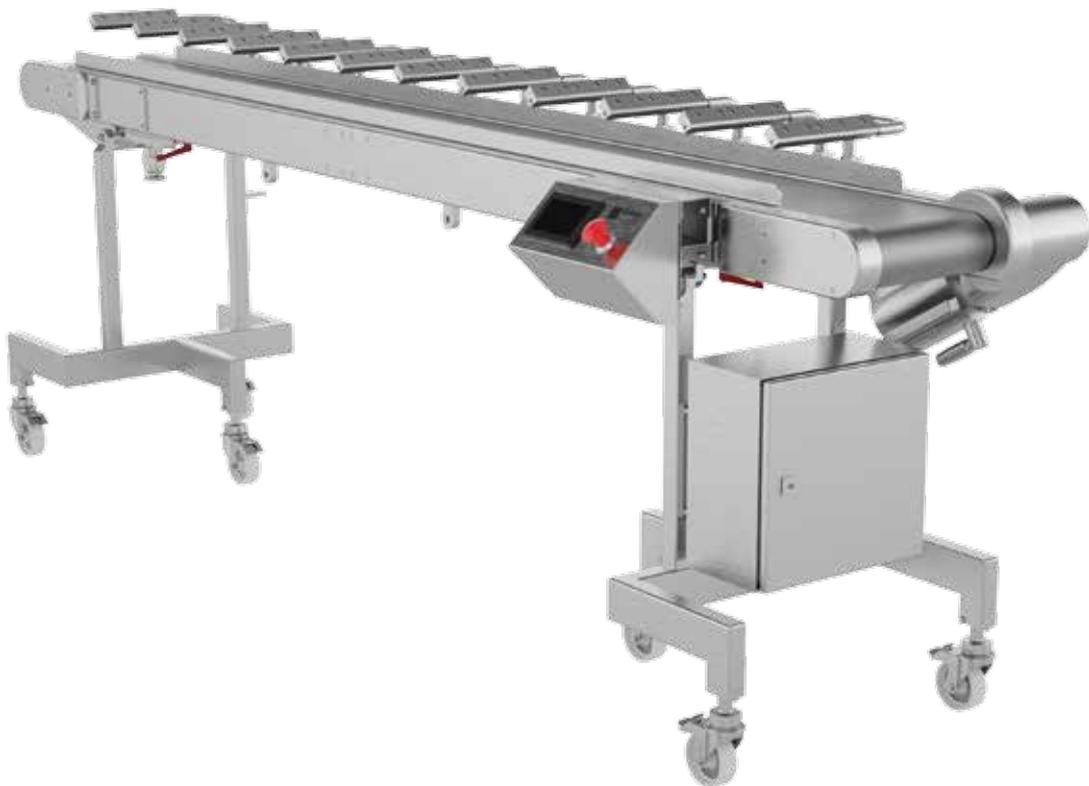
Anders als die konventionelle Extrusion im Wasserbad benötigt das Strang-Kühlband PFS keine manuelle Einfädung der Polymerstränge. Diese werden direkt auf ein Förderband abgelegt und automatisch zum Strangpelletierer gefördert. Die Kühlung erfolgt durch spezielle Luftdüsen mit hoher Kühlleistung.
