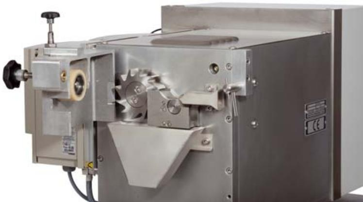
Werkzeugloser Zugang und einfach zu reinigende Schneidkammer.
