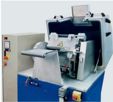
Sämtliche mit dem Kunststoff in Berührung kommenden Teile sind absolut korrosionsfrei. So ist z. B. das Granulatorgehäuseunterteil aus massivem rostfreien Stahl gefertigt. Das Oberteil aus seewasserbeständigem Aluminium.
