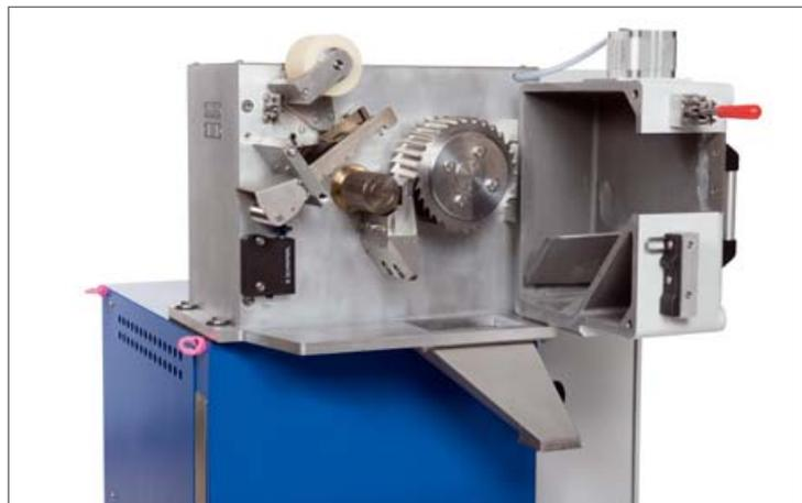
Die einfache Zugänglichkeit zum Schneidraum ermöglicht schnelle Reinigung und einfache Wartung.
