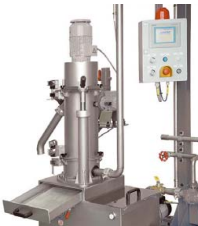
Feinstteile-Filterung in den Wassertank eingebaut
