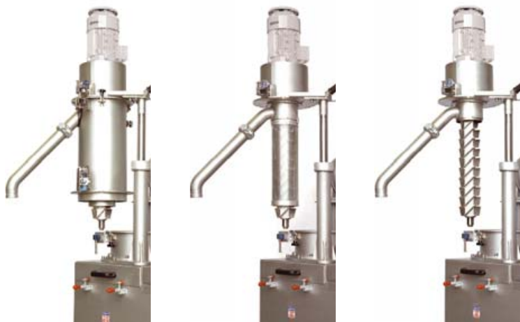
Von links nach rechts: Trockner Modell 1150: Gehäuse, Sieb und Rotor
