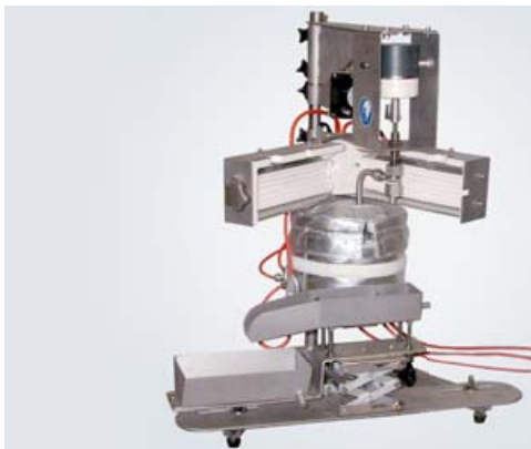
DROPPO® Mini mit Aufschmelzbehälter, Düsenkopf, Schwingerreger und Wasserbad
