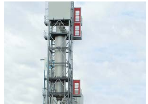
Vertropfungsturm einer DROPPPO® 300 Anlage für Chemikalien
