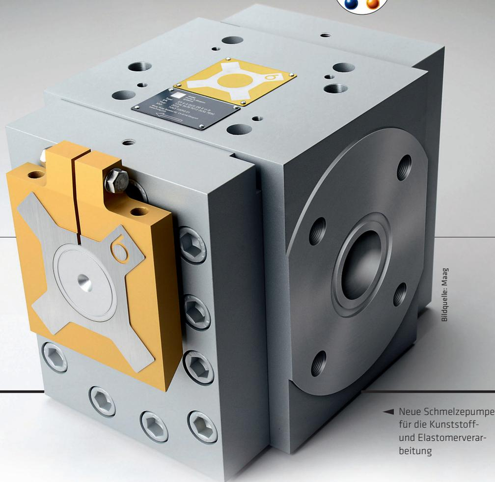
Zahnradpumpen nimmt ein rotierendes Zahnradpaar das Fördergut am Einlauf auf und transportiert es zum Auslauf, wobei die Fördermenge durch das Volumen zwischen den Zähnen und die Drehzahl der Zahnräder bestimmt wird. Aufgrund dieser Arbeitsweise kommen Zahnradpumpen in der Compoundierung bevorzugt zum Einsatz und tragen dazu bei, eine stabile, stoßfreie und kontrollierte Fördermenge zu erzeugen, die zur Optimierung der Gleichmäßigkeit der Schmelze beiträgt.
