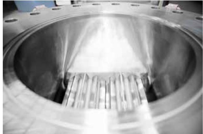
**Bild 2.** Ansaugöffnung einer Zahnradpumpe des Typs Maag x<sup>6</sup> class zum Austrag von Polymer aus Vakuum (© Maag)
