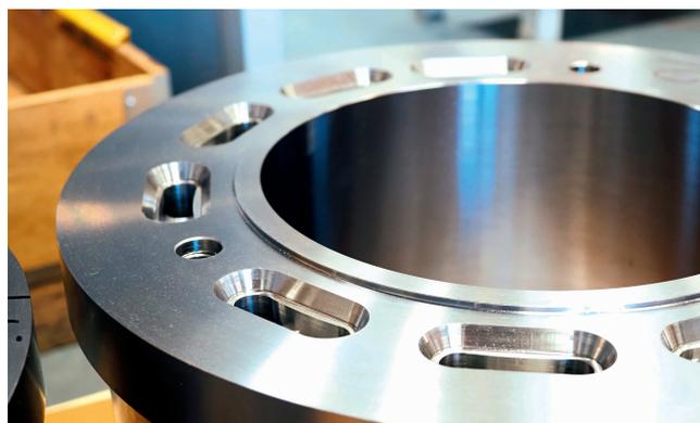
Diese Sonderanfertigung für einen Kunden enthält Kühlkanäle, durch die später Wasser oder ein anderes Kühlmedium fließen kann. © Hanser/Schröder
