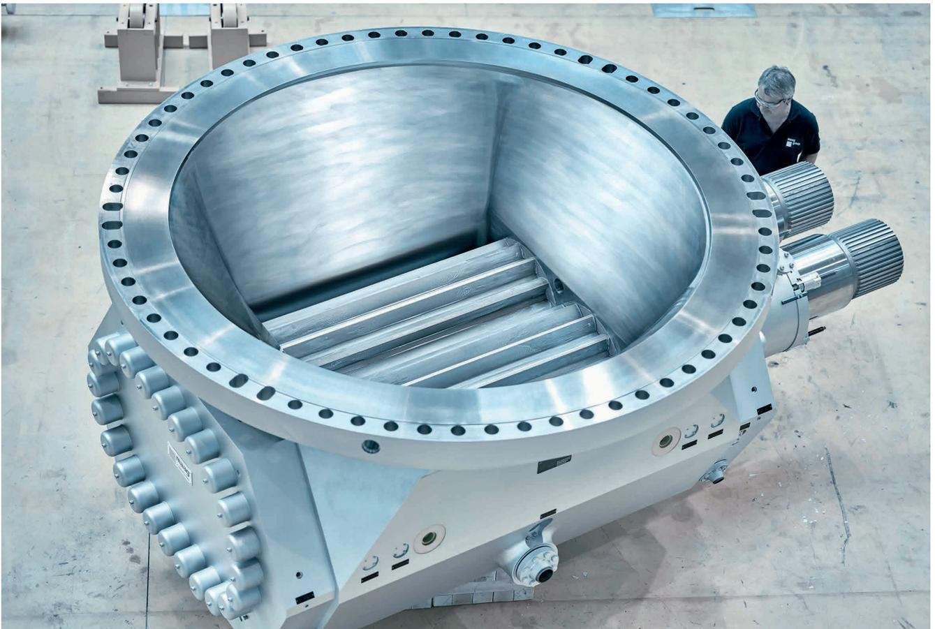
Diese ultrarex-Pumpe fürs Compounding hält mit ihren Maßen den firmeneigenen Rekord: Sie wiegt 48 t, bringt es auf eine Pumpenlänge von 4 m und arbeitet mit einem Durchsatz von 50 t/h. © Maag
