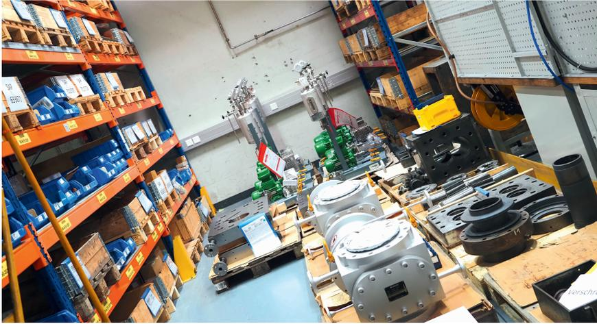
Blick ins Lager von Maag. 80 % der gefertigten Pumpen sind Standardlösungen, die aus einem modularen Baukastensystem konfiguriert werden und permanent auf Lager sind. © Hanser/Schröder
