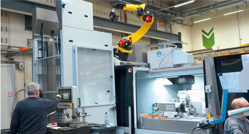
Kleinere Ausführungen werden in größeren Serien produziert. Hierfür ist der Maschinenpark so ausgelegt, dass er mannlose Schichten fahren kann. Hier im Bild ist ein Roboter zu sehen, der zwei Schleifzentren bedient. © Hanser/Schröder
